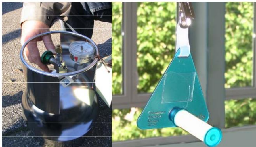
FIGURE 7 : DISPOSITIFS DE PRELEVEMENTS : CANISTER (A GAUCHE) ET TUBE A DIFFUSION (A DROITE)
